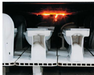
Высушенные и покрытые глазурью заготовки подвергаются обжигу при максимальной температуре 1240 °C.
