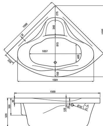
При заказе акриловой ванны в комплекте следует указывать два артикула — ванны и соответствующего монтажного комплекта. В монтажный комплект входят каркас, комплект креплений к стене, комплект креплений фронтальной панели, система слив-перелив (полуавтомат).
