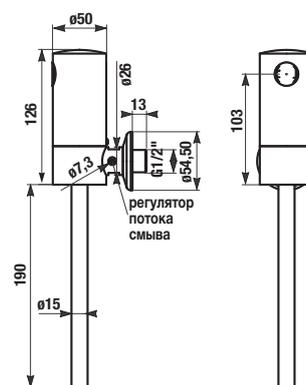
В комплект входит корпус из нержавеющей стали, шаровый вентиль, латунные шурупы для установки, пластиковый инсталляционный короб с соленоидным клапаном.
