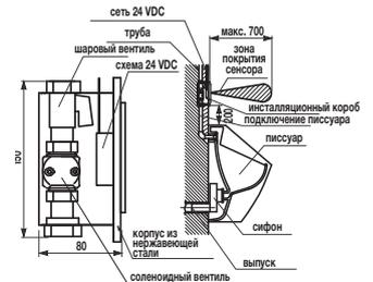
В комплект входит корпус из нержавеющей стали, шаровой вентиль, латунные шурупы для установки, пластиковый инсталляционный короб с соленоидным клапаном.
