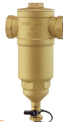
Zeparo Cyclone – циклонный сепаратор шлама, предназначенный для удаления взвешенных частиц из систем отопления, теплоснабжения и холодоснабжения. Благодаря циклонной технологии удалят до 45% взвешенных частиц за один проход. Опционально может быть оснащён изоляцией со встроенными магнитами для удаления магнитных частиц.
